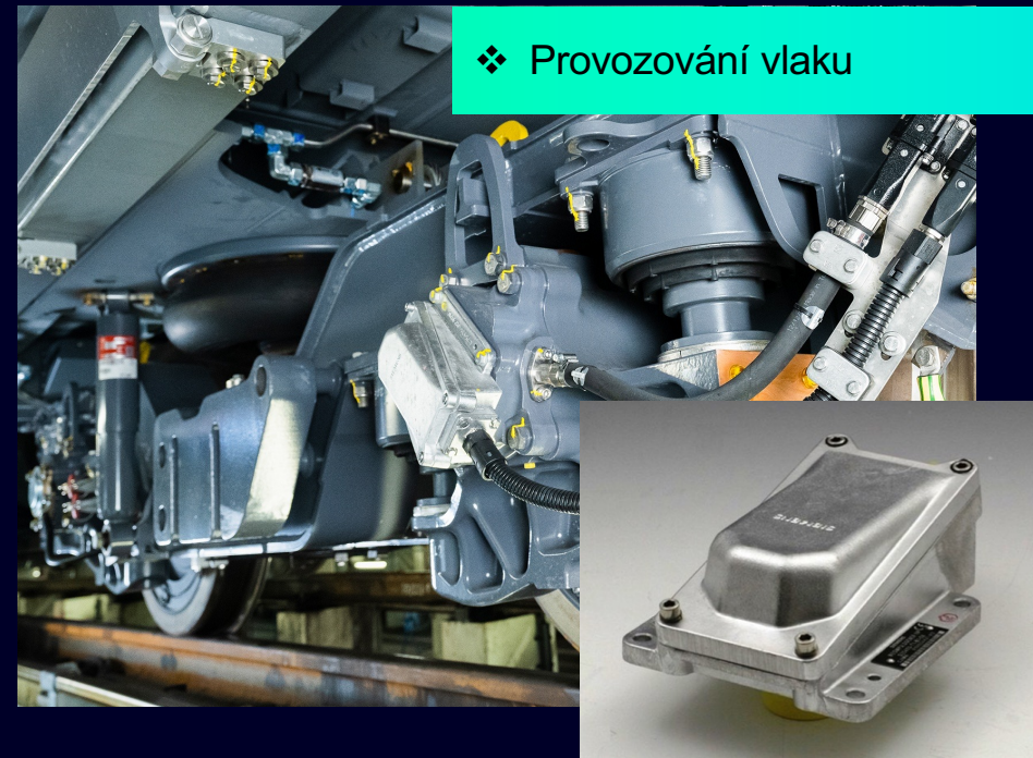
Pulsní generátor odometry (OPG - lokalizace, rychlost a směr) - Ilustrační foto
